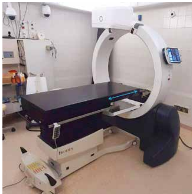
2. ÁBRA. Gyűrűs elrendezésű, mobilis, digitális röntgenképképző berendezés (ImagingRing) 2D-s és 3D-s képalkotáshoz (kúpsugaras CT) a speciális kezelőasztallal. A kettős nyíl mutatja az asztalnak azt a részét, amely nem tartalmaz fémet, ezért 3D-s képalkotáshoz is használható
