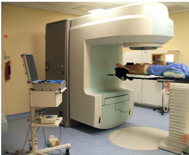
3. ábra. Légzéskapuzott kezelés beállítása a Siemens Artiste lineáris gyorsítón
