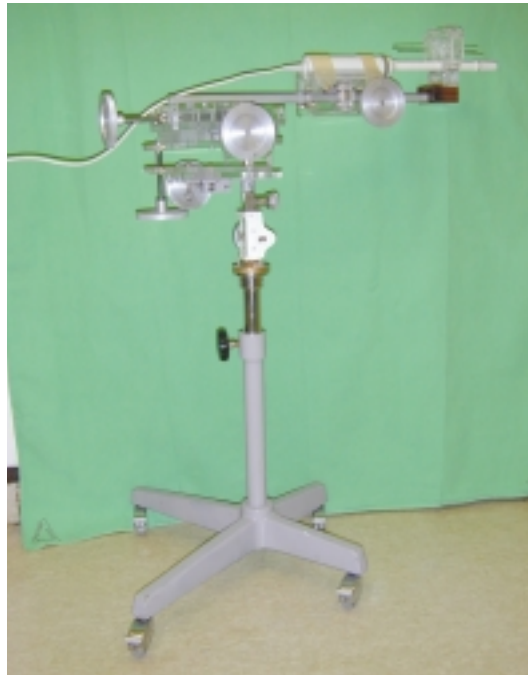
1. ábra. Az UH-fejet rögzítő-léptető, a tér minden irányában állítható állvány
